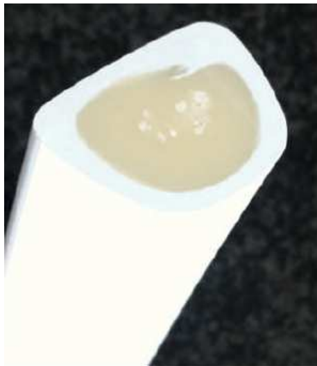
Rys. 63. Rdzeń z ABS wzmocniony 30% dodatkiem włókien szklanych oraz skóra z ASA nadaje temu uchwytowi stabilność oraz funkcjonalność (Zdjęcie: Weber Werkzeugbau)
