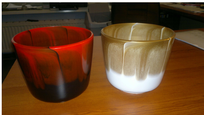
Rys. 55. Doniczki. Uzyskany efekt wizualny dzięki przedawkowaniu komponentu rdzenia (Zdjęcie: A. Jeran)
