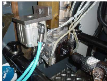
Rys. 10. Głowica przekazująca na wtryskarce wyposażonej w monosandwich [8]
