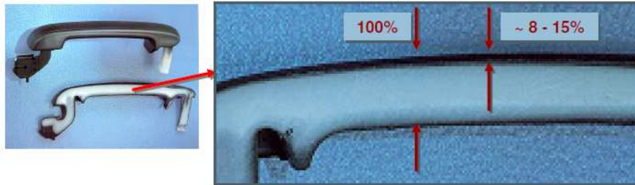
Rys. 56. Klamka samochodowa. Zaznaczony stosunek TWW do TWR [8]
