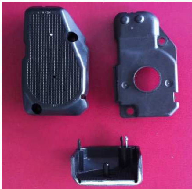
Rys. 65. Części obudowy osłony przekładni z rdzeniem wykonanym z miękkiego TPE w celu stłumienia dźwięków (Zdjęcie: Kraft)
