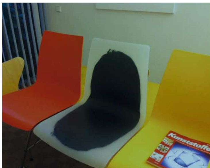
Rys. 64. Siedzisko tego krzesła wzmocnione jest wewnątrz domieszką 40% włókien szklanych. TWW bez barwnika pozwala zobaczyć komponent rdzenia (Zdjęcie: Kraft/Owi GmbH)
