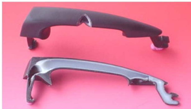
Rys. 33. Klamka samochodu wykonana w kombinacji technologii monosandwich ze wspomaganie gazem [8]
