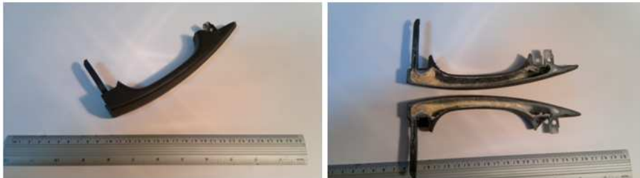
Rys. 57. Klamka w całości i przekroju. Widoczne usztywnienie za pomocą WS. (Zdjęcie: A. Jeran)
