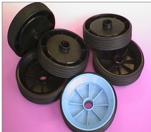
Rys. 42. Kółka wyprodukowane w systemie monosandwich i techniki formy [8]
