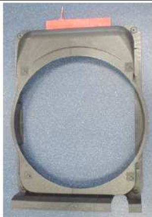
Rys. 37. Rama wentylatora chłodnicy ciężarówki [8]
