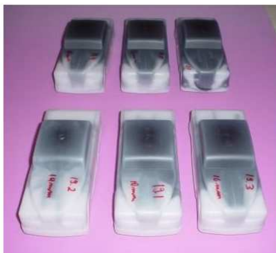
Rys. 28. Badanie wypełnienia z dodatkiem komponentu rdzenia z zachowaniem równej objętości całkowitej [8]
