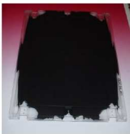
Rys. 18. Pokrywa jako przykład geometrii płytowej wypraski. Komponent TWW jest specjalnie transparentny, tak aby widać było komponent rdzenia [8]
