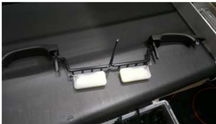
Rys. 58. Wypraska widoczna w całości z systemem wlewkowym oraz gniazdamy bocznikowymi (Zdjęcie: A. Jeran)
