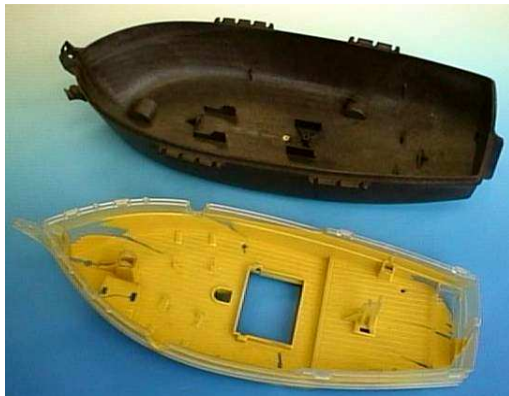
Rys. 48. Dno statku zabawki. Komponent TWW dla uwidocznienie rdzenia transparentny [8]
