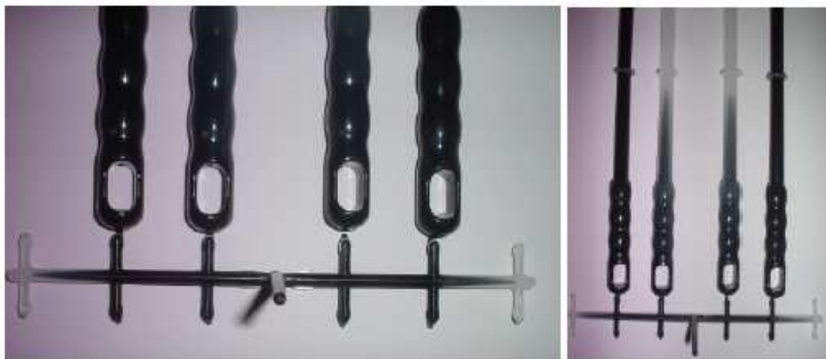
Rys. 24. Efekty wizualne świadczące o niezrównoważonym (niezbalansowanym) rozdzielaczu w układzie przepływowym (wlewowym) [8]
