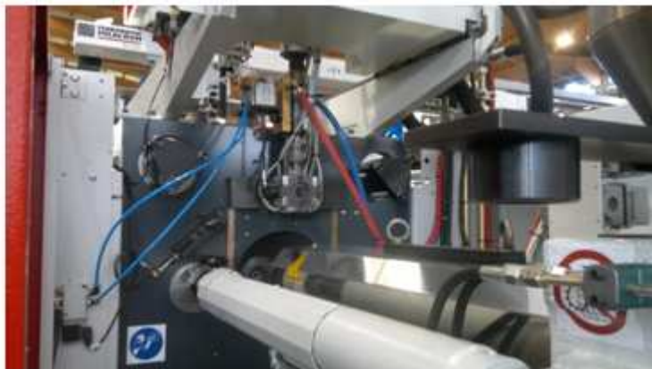
Rys. 59. Wtryskarka Ferromatik K-TEC 200 MSW. Widoczna głowica podająca agregatu wytłaczarskiego w wersji pionowej (Zdjęcie: A. Jeran)
