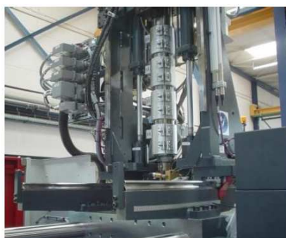
Rys. 11. Boczny poziomy i górny pionowy model montażu dodatkowego agregatu „mono” [8]
